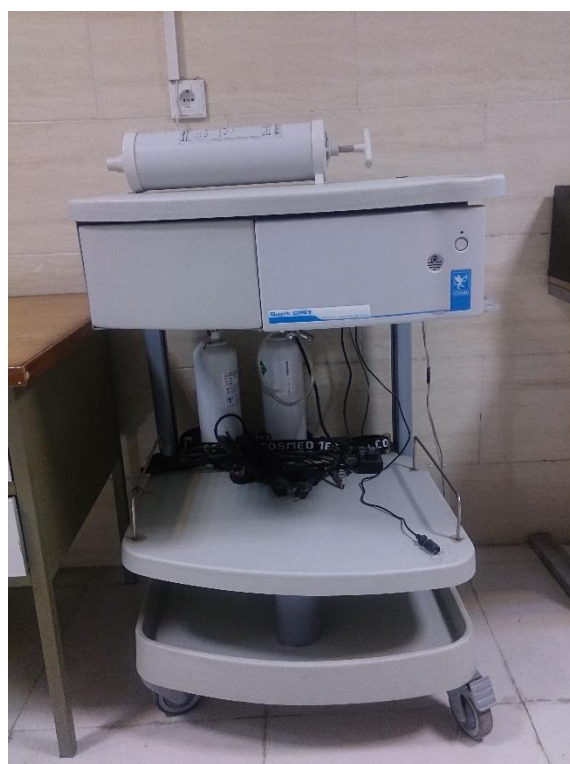
شکل ۵. دستگاه ارگواسپیرومتر (Cardio Pulmonary Exercise Testing System)
